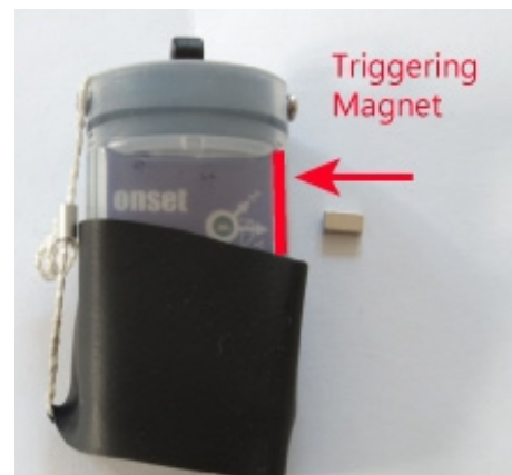
Abbildung 4: Starten des Sensors: Abschirmen von Sonnenlicht vom unteren Teil des Sensors und Magnet drei Sekunden an die bezeichnete Stelle halten.
